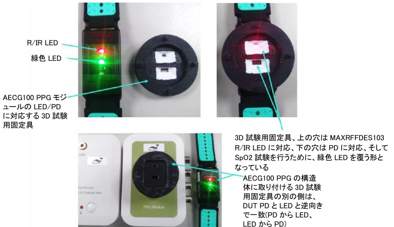
図 2 3D プリント固定具を AECG100 PPG の固定具ベースにしっかりと固定
