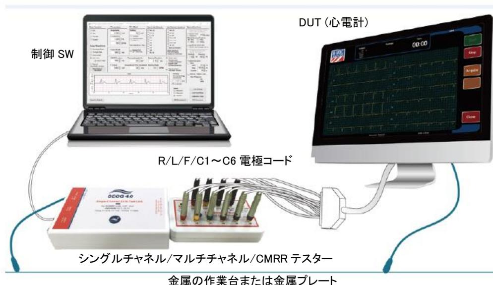
図 3: EUT 心電計に接続された心電計テスター、試験システムの図
