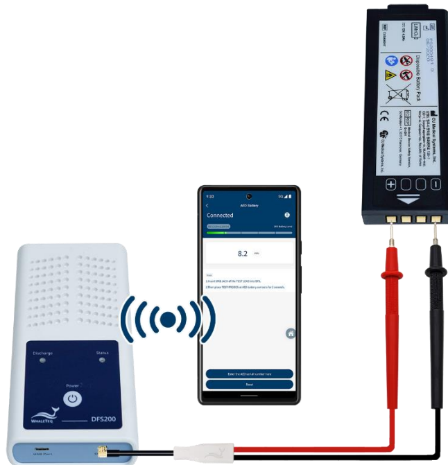
図 3: バッテリー計測用プローブ(負荷対応)で AED 用バッテリーを測定
